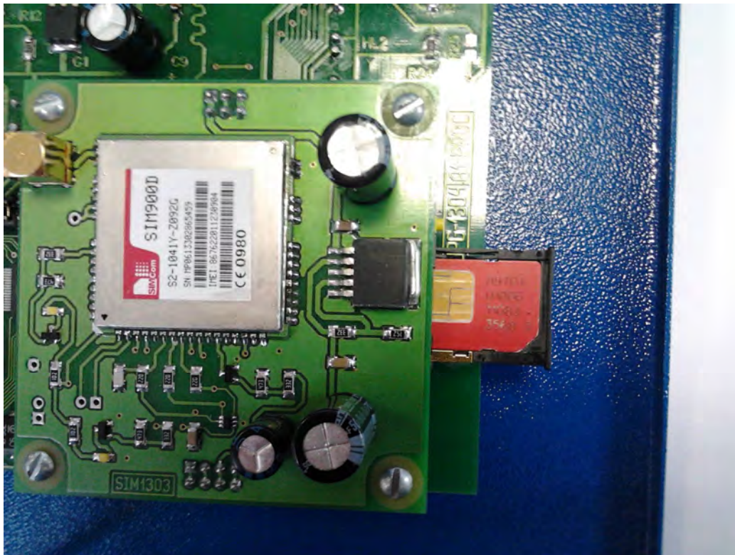
Рис.6.5. Установка лотка на место.
